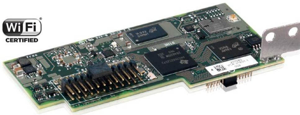
**La nuova VSN300 Wifi Logger Card è una scheda di espansione per gli inverter di stringa UNO e TRIO di ABB che offre ai proprietari di installazioni residenziali e commerciali una soluzione avanzata e conveniente per il monitoraggio e il controllo del loro impianto fotovoltaico.**
