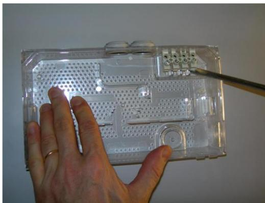
**6** Déclipser le connecteur femelle du boîtier en faisant levier avec un tournevis.
