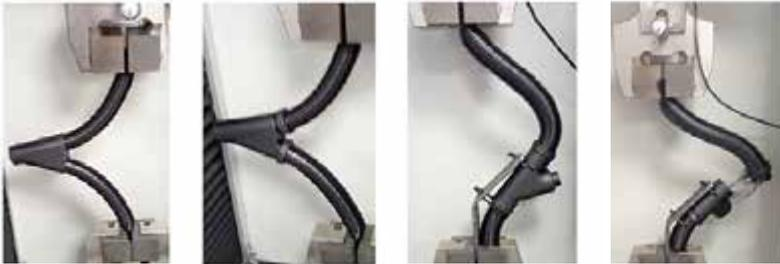
CCSB-Clips sind so konzipiert, dass sie geschlitzte Wellrohre sicher schließen und somit freiliegende Leitungen verhindern. Auf diese Weise wird das Risiko für Beschädigungen der Kabel reduziert, die Druckfestigkeit von geschlitzten Wellrohren erhöht und eine verbesserte Haltekraft bei allen IP40-Kabelschutzsystemen von Harnessflex ermöglicht.
