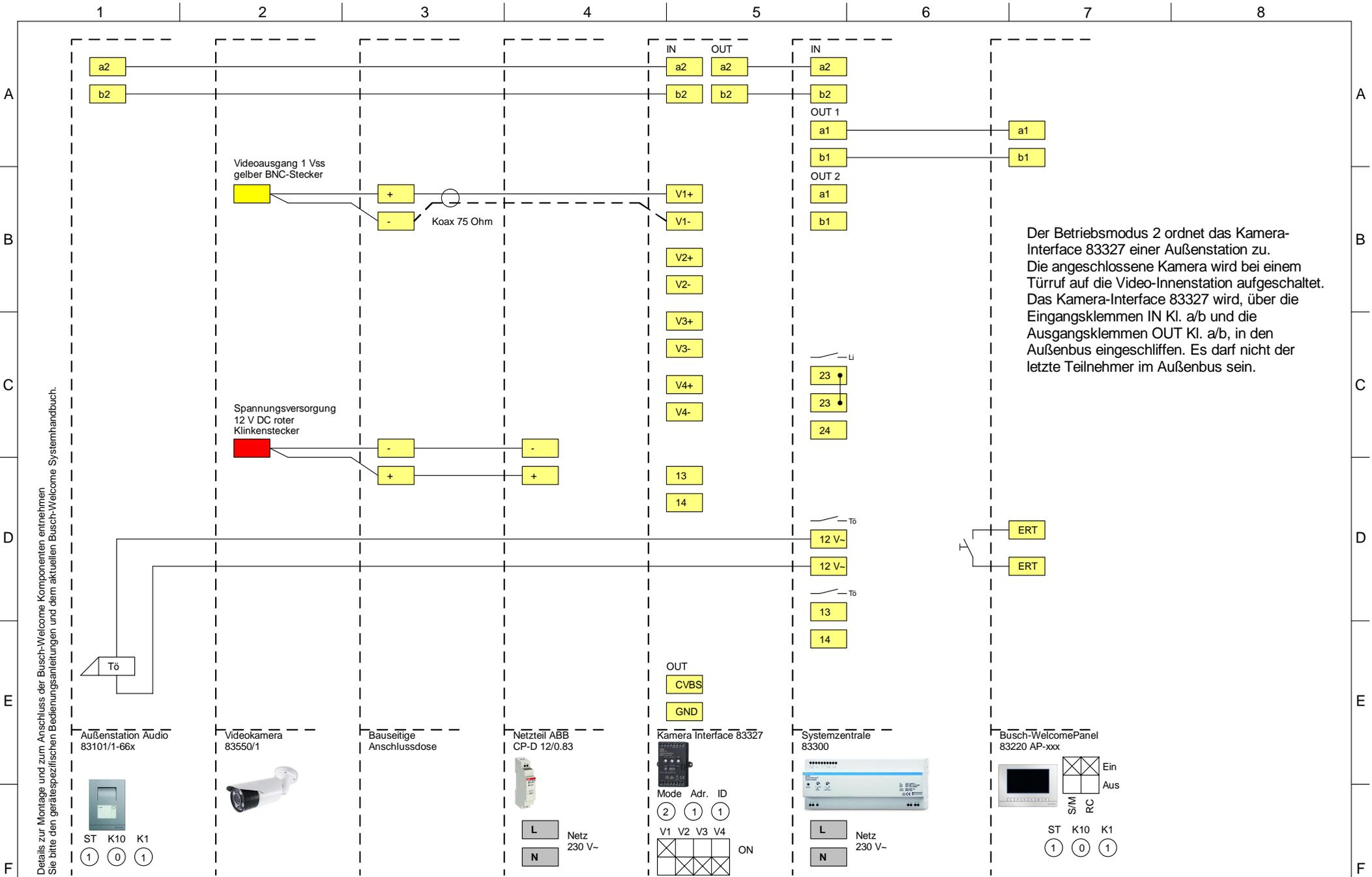
Details zur Montage und zum Anschluss der Busch-Welcome Komponenten entnehmen Sie bitte den gerätespezifischen Bedienungsanleitungen und dem aktuellen Busch-Welcome Systemhandbuch.
