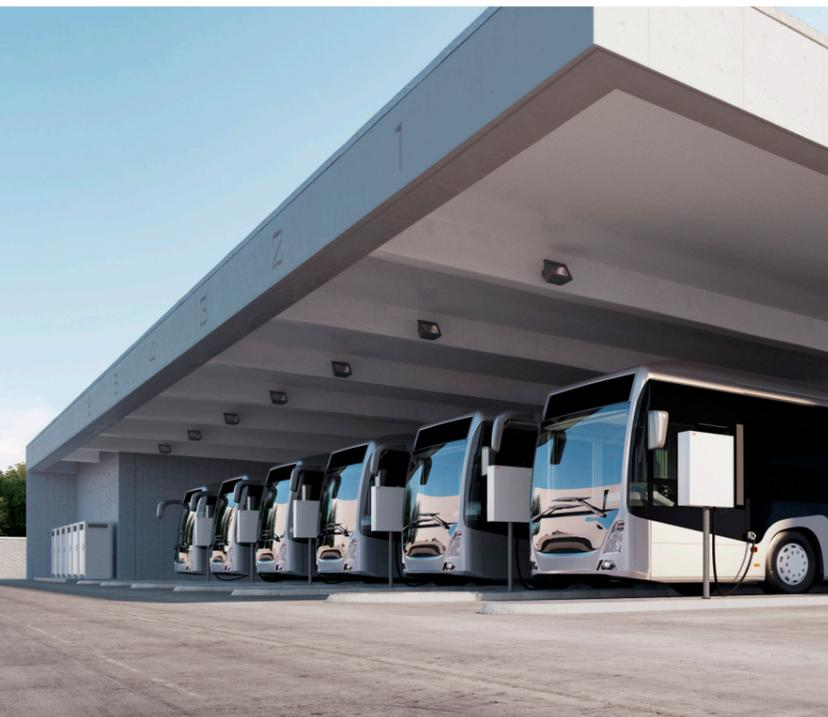
Aumente a eficiência e reduza os custos com a solução de carregamento inteligente para estações de veículos pesados. Este sistema permite que até três autocarros elétricos ou camiões sejam conectados e carregados sequencialmente enquanto estacionados. A lógica programada no posto de alimentação na estação de camiões "acorda" cada veículo para os carregar, e coloca-os de novo no modo "sono" quando a carga está completa.
