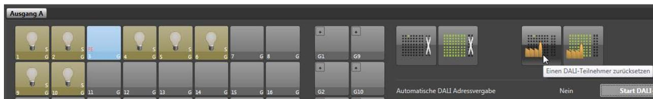
Vorteil: Kein Entfernen der DALI Vorschaltgeräte aus der Installation notwendig, einer der beiden Teilnehmer erhält die nächste freie DALI Adresse, eine Umadressierung ist bei Bedarf mit dem i-bus tool leicht möglich.
