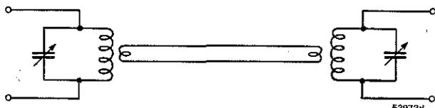
Abb. 1. — Koppelschaltung zweier durch Energieleitung verbundener Schwingungskreise.
