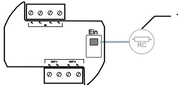
Abb. 2: Abschlusswiderstand am Gerät setzen
