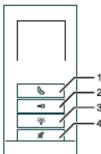
Abb. 1: Tasten am Gerät
