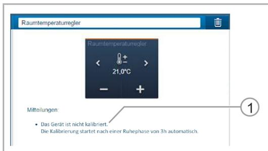
Abb. 12: Kalibriervorgang bei Erstinbetriebnahme
