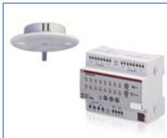
Der ABB-KNX-DALI-Lichtregler DLR/S 8.16.1 M verbindet die digitale Beleuchtungssteuerung DALI mit der Gebäudesystemtechnik KNX und ermöglicht gleichzeitig eine energieeffiziente Konstantlichtregelung. Am DALI-Ausgang des DLR/S sind bis zu 64 DALI-Teilnehmer anschliessbar. Die 64 DALI-Teilnehmer können individuell adressiert und beliebig bis zu 16 Leuchtengruppen zugeordnet werden.
