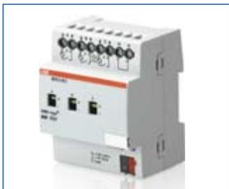
Der neue ABB-KNX-Energieaktor SE/S 3.16.1 ist ein Schaltaktor, der den Energieverbrauch der angeschlossenen elektrischen Verbraucher erfasst. Zählerwerte können zyklisch, auf Anforderung oder bei Eintritt eines Start- oder Stoppereignisses wie z. B. Uhrzeit, Betriebsdauer oder beim Erreichen einer definierten Verbrauchsgrenze gesendet werden.
