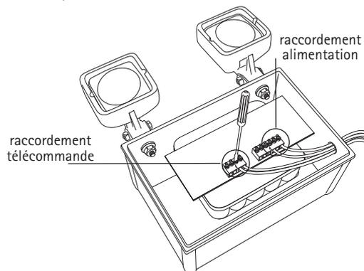
**D** Brancher les fusibles dans le porte-fusible. Insérer le câble d'alimentation par le presse-étoupe situé sur le côté de l'appareil. Effectuer le raccordement des conducteurs dans les borniers implantés sur la carte électronique.
