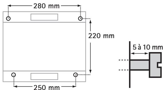
**B** Effectuer le traçage sur le mur à l'aide du croquis ci-dessus. Visser les 4 vis dans le mur en laissant un espace d'environ 5 à 10 mm.
