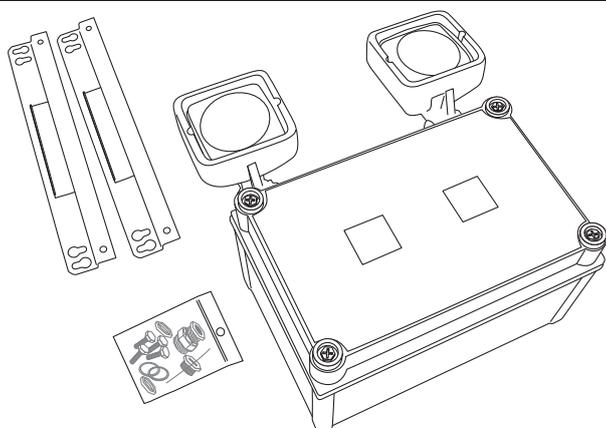
L'emballage contient l'appareil, un sachet de 4 vis 6 x 20 et 2 barres de fixation métalliques.
