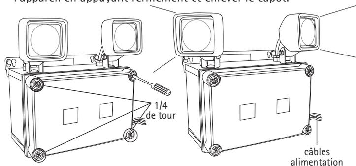
**E** Remettre le capot en place et serrer les vis d'un quart de tour en appuyant fermement. Orienter les projecteurs de façon à optimiser l'éclairage du local.
