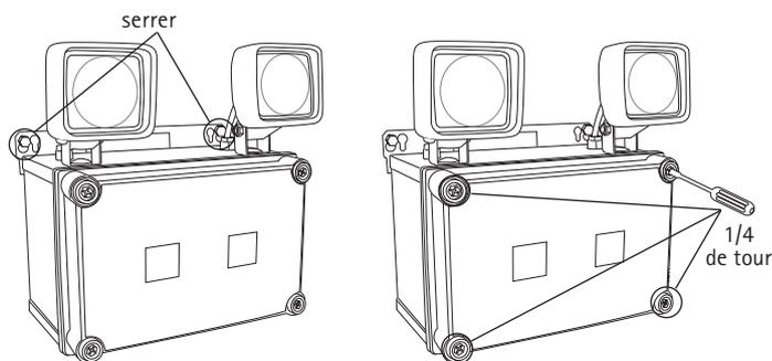
**C** Accrocher l'appareil sur les vis puis serrer celles-ci pour obtenir une fixation durable. Dévisser les 4 vis (1/4 de tour) situées sur l'avant de l'appareil en appuyant fermement et enlever le capot.
