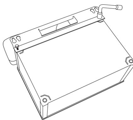
**A** Fixer les 2 barres de fixations à l'aide des vis 6 x 20.
