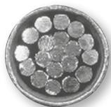
До обжатия типичное поперечное сечение кабеля и наконечника состоит приблизительно из 75 % металла и 25 % воздуха.
