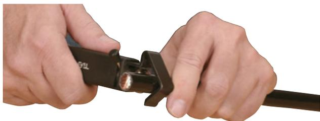
Аккуратно снимите изоляцию с проводов, не находящихся под напряжением, не допуская надразов и не срезая проводники (при необходимости очистите проволочной щеткой).
