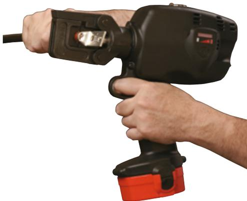
При выполнении нескольких обжатий делайте первое обжатие у клеммы, а затем двигайтесь в сторону корпуса. При правильном обжатии кодовый номер штампа будет выдавлен на наконечнике. Это облегчает проверку правильности использованной комбинации штампа и наконечника.
