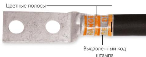
Штампы, используемые в ручных и гидравлических инструментах АВВ, содержат номера «кодов штампов», выгравированные на поверхности обжатия штампа. При обжатии этот номер выдавливается на готовом соединении для последующей проверки. Инспектор сверяет кодовый номер штампа, выдавленный на наконечнике, с таблицей штампов, чтобы убедиться, что наконечник был обжат правильным штампом, подходящим для данного конкретного размера проводника.
