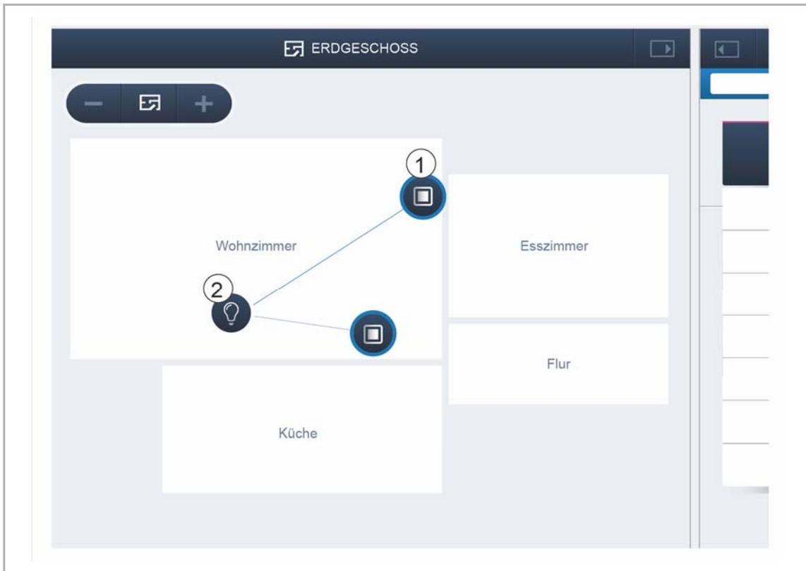
Abb. 23: Aktor mit einem weiteren Sensor verknüpfen
