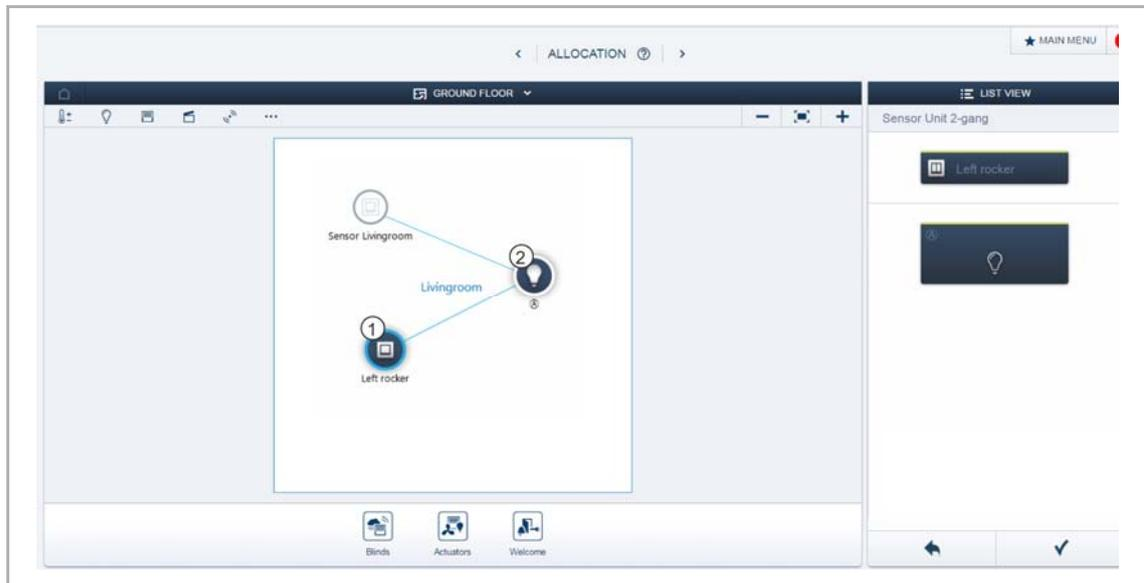
Fig. 18 : Relier l'actionneur à un autre capteur
