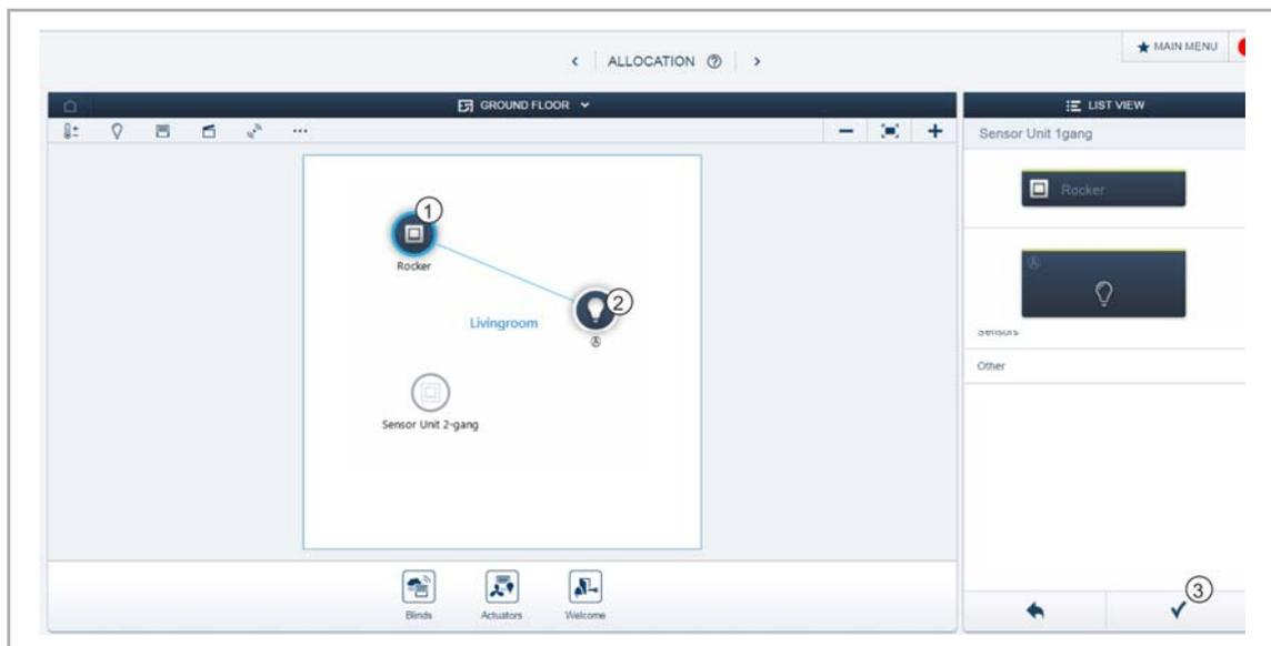
Fig. 17 : Relier actionneur et capteur
