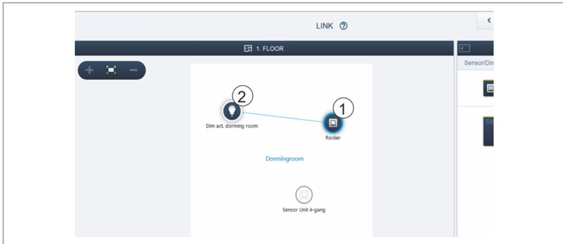
Εικ. 21: Σύνδεση ενεργοποιητή και αισθητήρα
