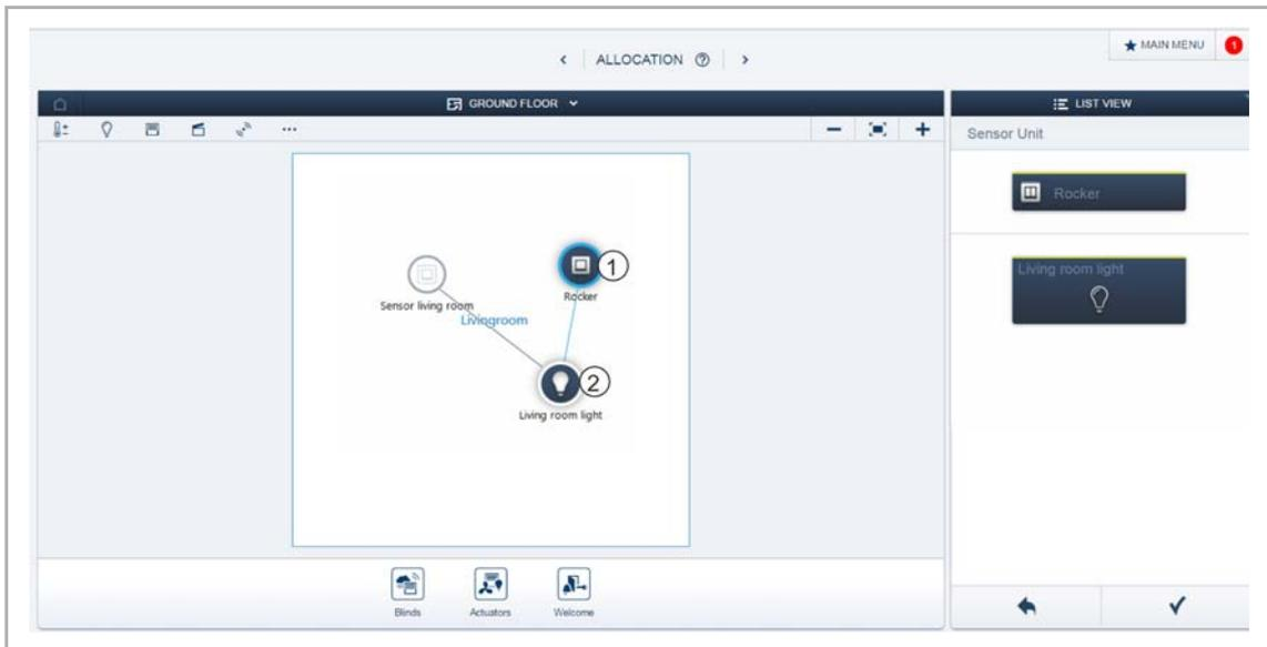
Fig. 22: Collegamento di un attuatore a un ulteriore sensore
