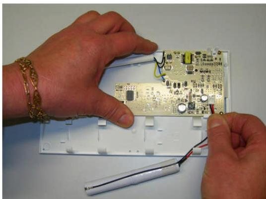
**4** Déclipser la batterie de son support sur le réflecteur. Déconnecter le connecteur de batterie en tirant sur les conducteurs.
