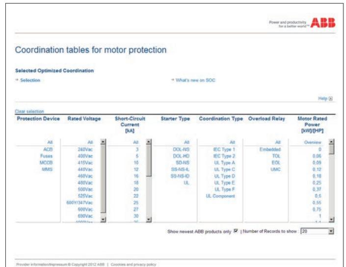
1. Protection Device (Dispositivo de Proteção): quais serão os tipos de dispositivos de proteção admitidos na partida a ser dimensionada.
