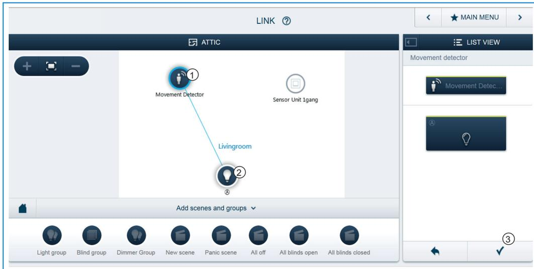
Fig. 11: conectar atuador e sensor
