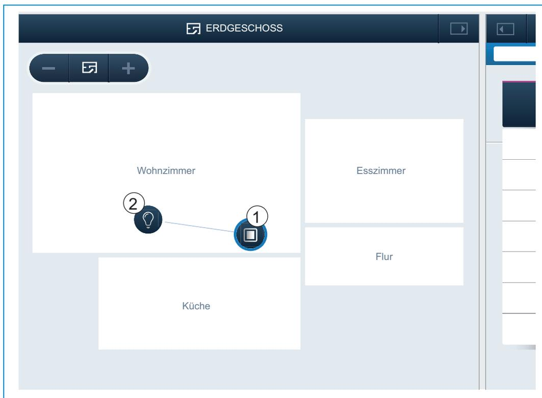
Abb. 13: Aktor und Sensor verbinden
