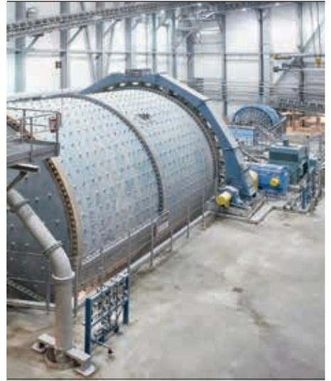
L'exemple de circuit SAG de grande capacité → 3 consomme toutefois beaucoup d'énergie spécifique par tonne de minerai traité, essentiellement à cause du rendement médiocre des broyeurs à boulets et de l'utilisation de sphères d'acier comme corps broyants.
