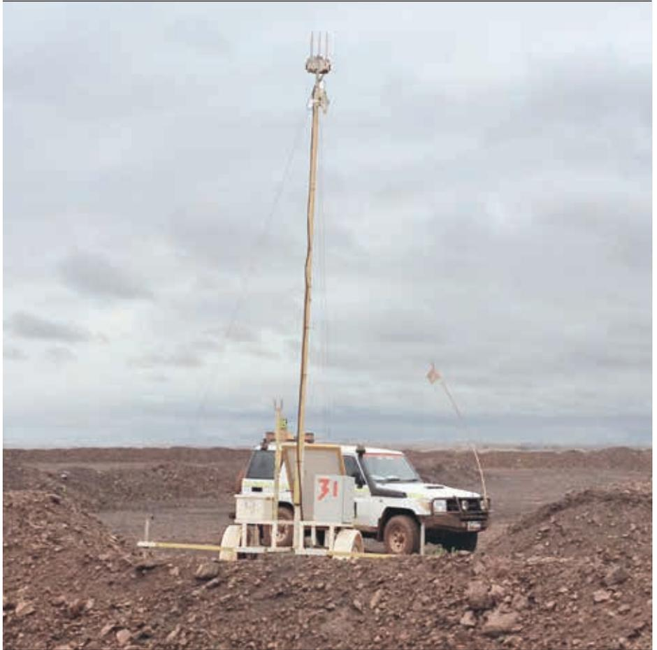
mission. La solution de routeurs Tropos d'ABB conjugue haute disponibilité et fiabilité grâce à une topologie maillée qui multiplie les itinéraires réseau, les fréquences d'exploitation, les canaux radio et les retransmissions de paquets.
