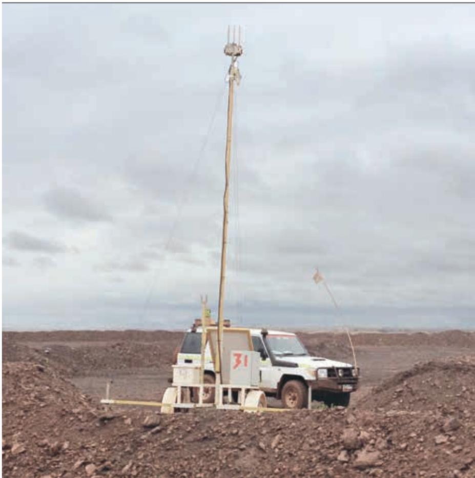
fehlern minimiert. Die ABB-Lösung garantiert eine hohe Verfügbarkeit und Zuverlässigkeit, da die Tropos-Router in einer vermaschten Topologie mit mehreren Pfaden durch das Netzwerk, dynamischen Betriebsfrequenzen, mehreren Funkgeräten und mehrfacher Wiederholung der Übertragung bei jedem Paket arbeiten.
