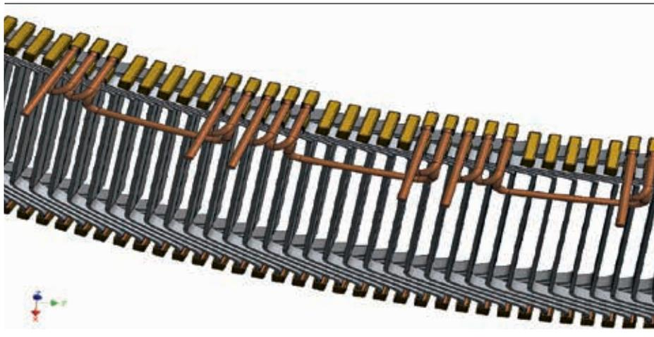
en zig-zag próxima no permite la construcción. Se da la misma situación entre el tapón aislante del puente de fase y la conexión en zig-zag inmediata. La falta de espacio impide construir este devanado empleando conexiones en zig-zag. Para buscar otra solución es necesario considerar la distancia mínima entre las conexiones y la viabilidad de la construcción y el aislamiento de la nueva geometría de conexiones.
