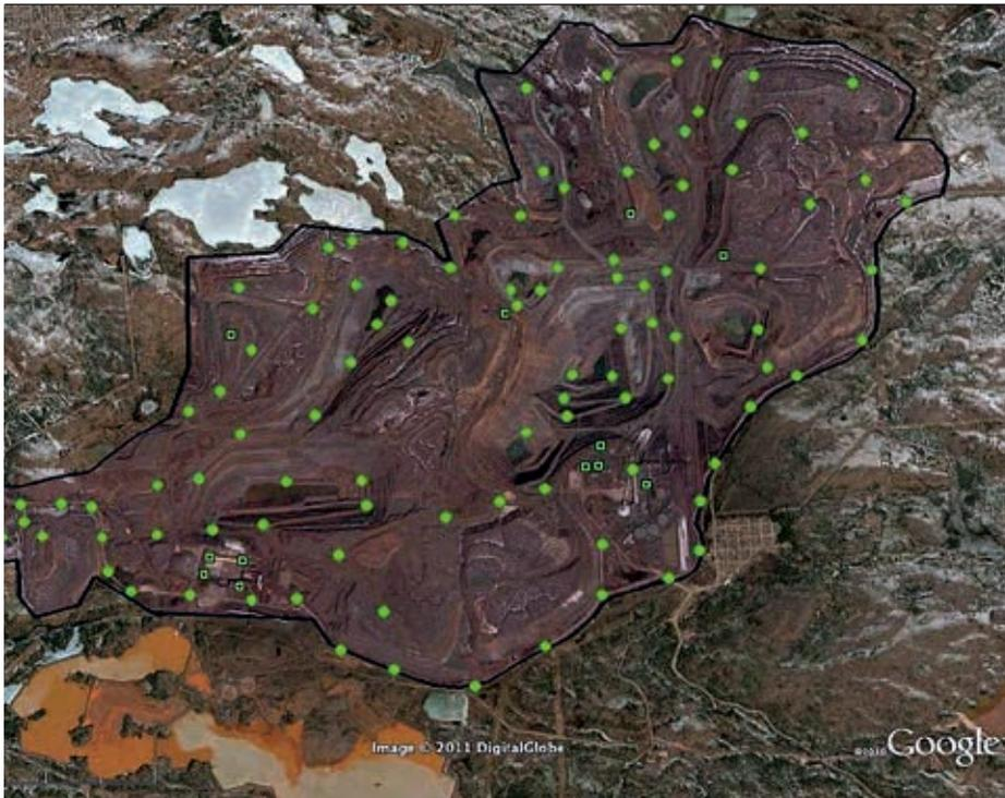
Con las redes mallas inalámbricas Tropos, los enrutadores desplegados en remolques alrededor de la corta se “descubren” unos a otros automáticamente y proporcionan cobertura completa para toda la excavación.
