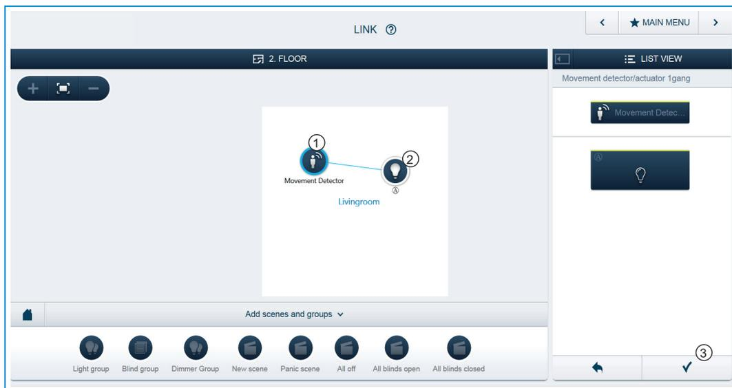
Fig. 14: Collegamento tra attuatore e sensore
