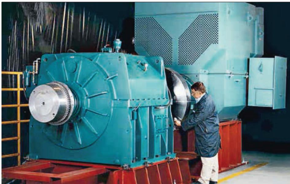
A ABB também disponibiliza as tecnologias mais recentes de accionamento para sistemas de tapetes transportadores, sob a forma de sistemas de accionamento de transmissão directa. Estes sistemas possuem configurações com motores síncronos de baixa velocidade e conversores de frequência que permitem uma redução do número total de componentes, traduzida por sua vez numa maior fiabilidade do sistema e em menores requisitos de manutenção.
