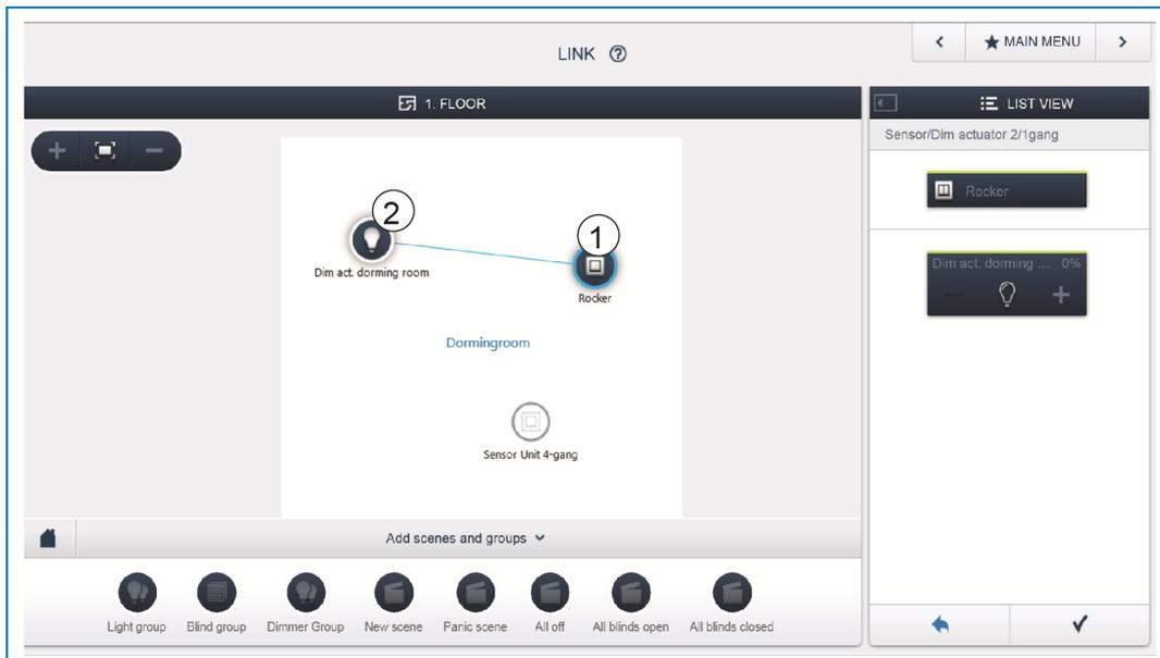
Fig. 24 : Relier actionneur et capteur
