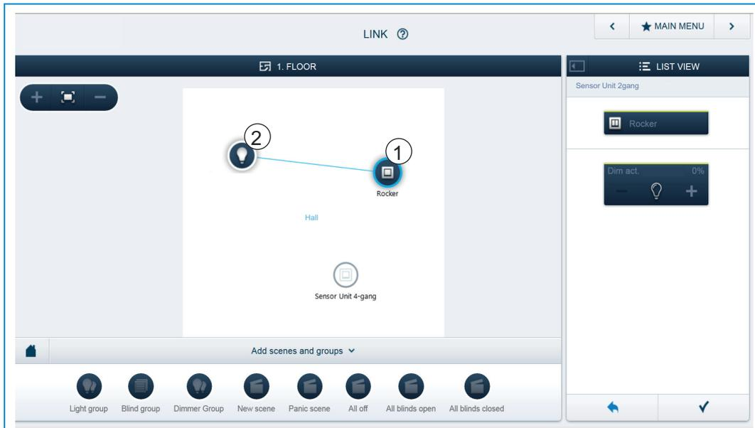
Fig. 14: Conectar atuador e sensor
