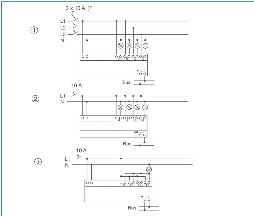
Fig. 4: posibilidades de conexión de los aparatos
