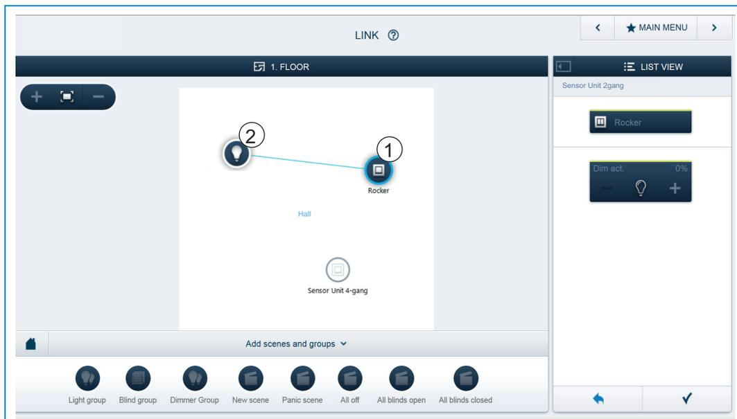
Fig. 14: Enlazar el actuador y el sensor
