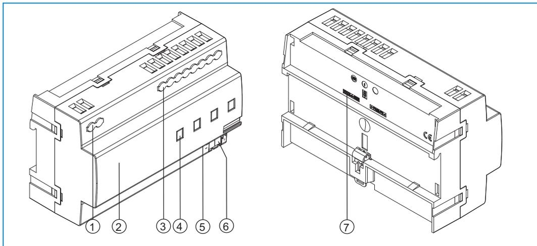
Fig. 2: Vista general actuador regulador de 4 elementos REG
