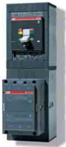
Na versão tripolar, os disjuntores Tmax T4, T5 e T6 são munidos com o relé de proteção PR222MP. Isso torna possível obter funções que garantem uma alta precisão de disparo, extremamente confiável e imune às variações da temperatura externa. A unidade PR222MP totalmente integrada ao disjuntor garante a proteção do motor. De fato, não é necessária a ajuda de um relé térmico externo para a proteção contra sobrecarga, o que ocorre na solução padrão.
