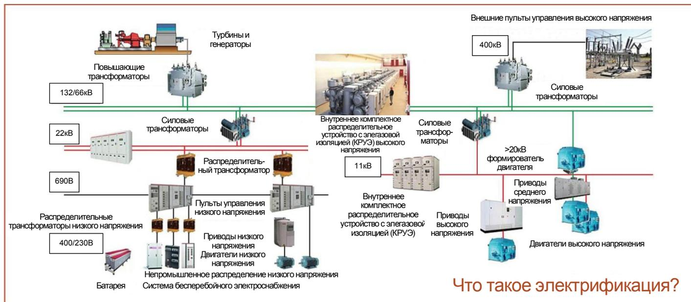
Электрификация АББ присутствует в полной цепочке создания добавленной стоимости в металлургической промышленности.
