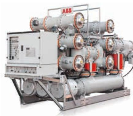
Este nuevo equipo GIS incorpora un interruptor automático de movimiento doble, rápido y de corte único y está diseñado para intensidades nominales de hasta 5.000 amperios (A). Proporciona protección para redes eléctricas con intensidades de cortocircuito nominales de hasta 63 kiloamperios (kA).
