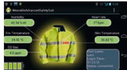
gases o temperatura así como sobre la condición sanitaria de la persona que lo lleva puesto. Por medio de aplicaciones de aumento de la realidad incorporadas en teléfonos móviles, tabletas o gafas especiales, el técnico que está a pie de obra puede obtener información de segundo plano que haga su trabajo más eficiente y seguro.
