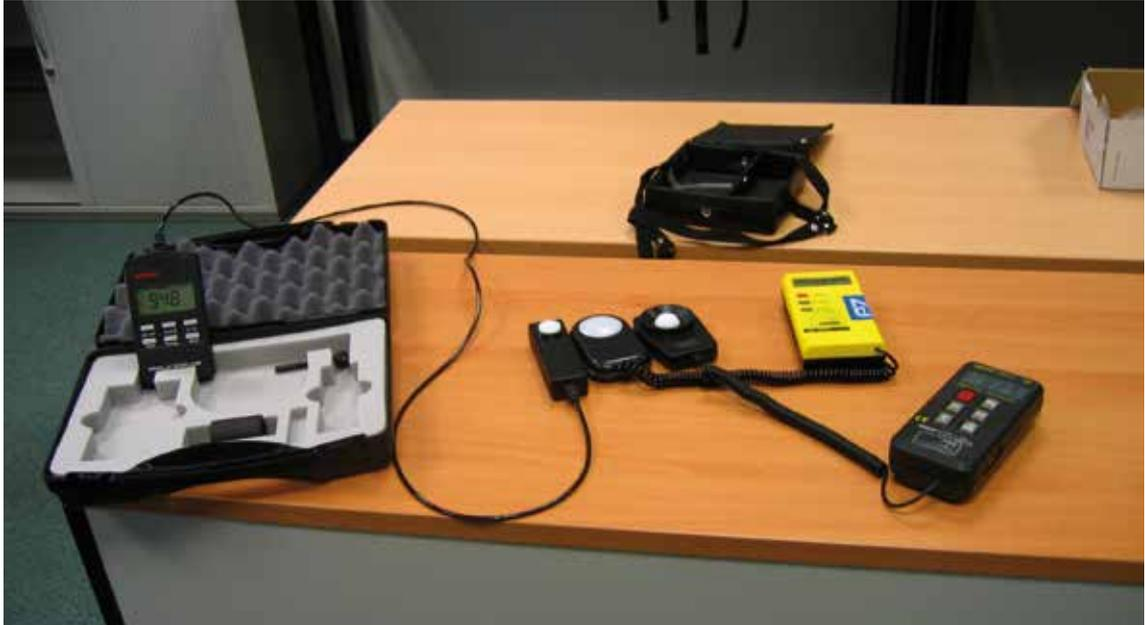
In dem obigen Bild zeigt das linke Messgeräte 948 lx, das mittlere (gelb) 765 lx und das rechte Messgerät 827 lx an. Die Unterschiede können dabei – abhängig davon, ob es sich um Tageslicht, Kunstlicht oder Mischlicht handelt oder ob sich die Geräte im Schattenbereich befinden oder direkt von der Sonne bestrahlt werden – größer oder kleiner sein.
