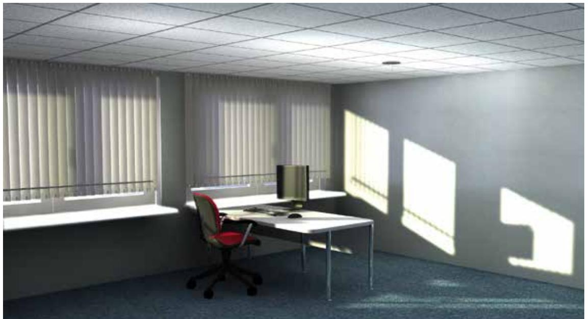
In diesem Bild sieht man deutlich die stark reflektierenden weißen Fensterbänke im Erfassungsbereich des Lichtfühlers, der nur etwa zwei Meter von den Fenstern entfernt montiert ist.
