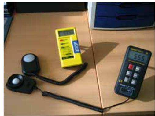
Am gleichen Messort zeigen, bei unterschiedlichen Beleuchtungsverhältnissen durch das einfallende Tageslicht mit leichter Schattenbildung, beide Geräte im linken Bild deutlich unterschiedlichere Werte und im rechten Bild nahezu den gleichen Wert an.
