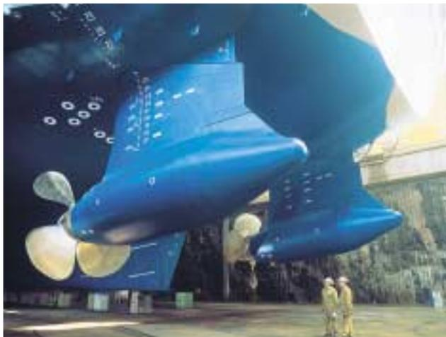
*Un sistema di propulsione Azipod*
