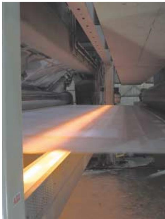
*Un QCS ABB per il controllo dello spessore della carta*
