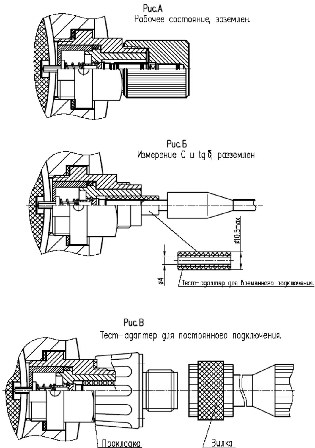
Рис. 8 Измерительный вывод
