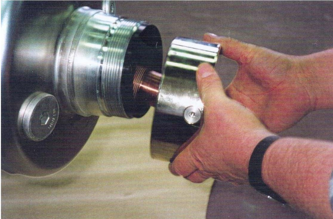
**Фото 6. Накручивание зажимной гайки на верхнюю часть расширителя**
