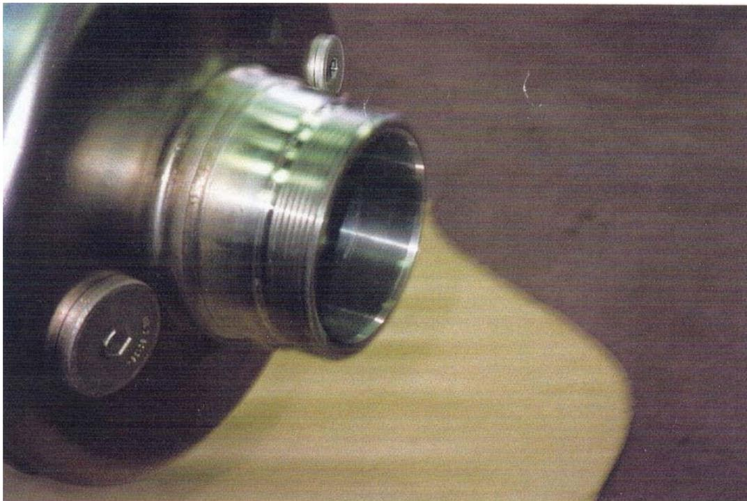
Фото 2. Установка кольца из алюминиевого сплава с надетыми на него четырьмя резиновыми уплотнительными прокладками
