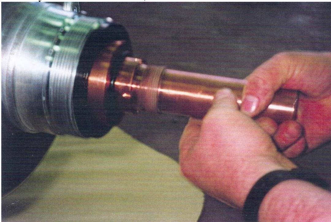
**Фото 5. Установка зажимной гайки**
