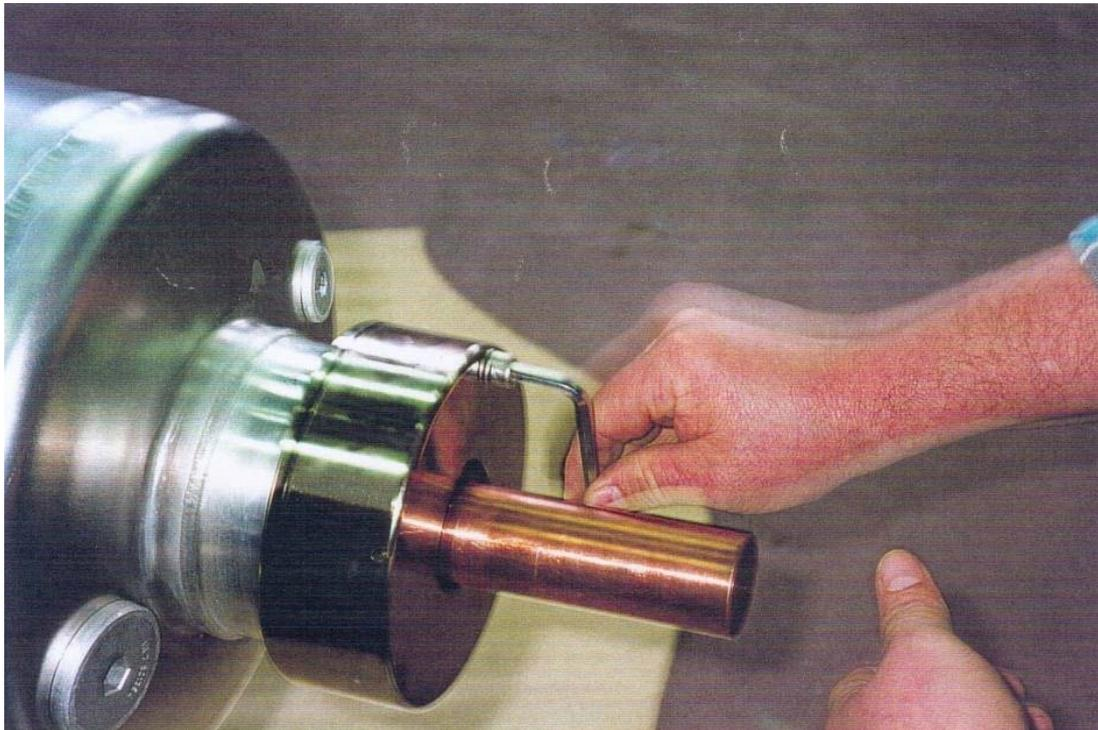
**Фото 8. Накручивание гайки М48×2 на внутреннюю контактную шпильку**
