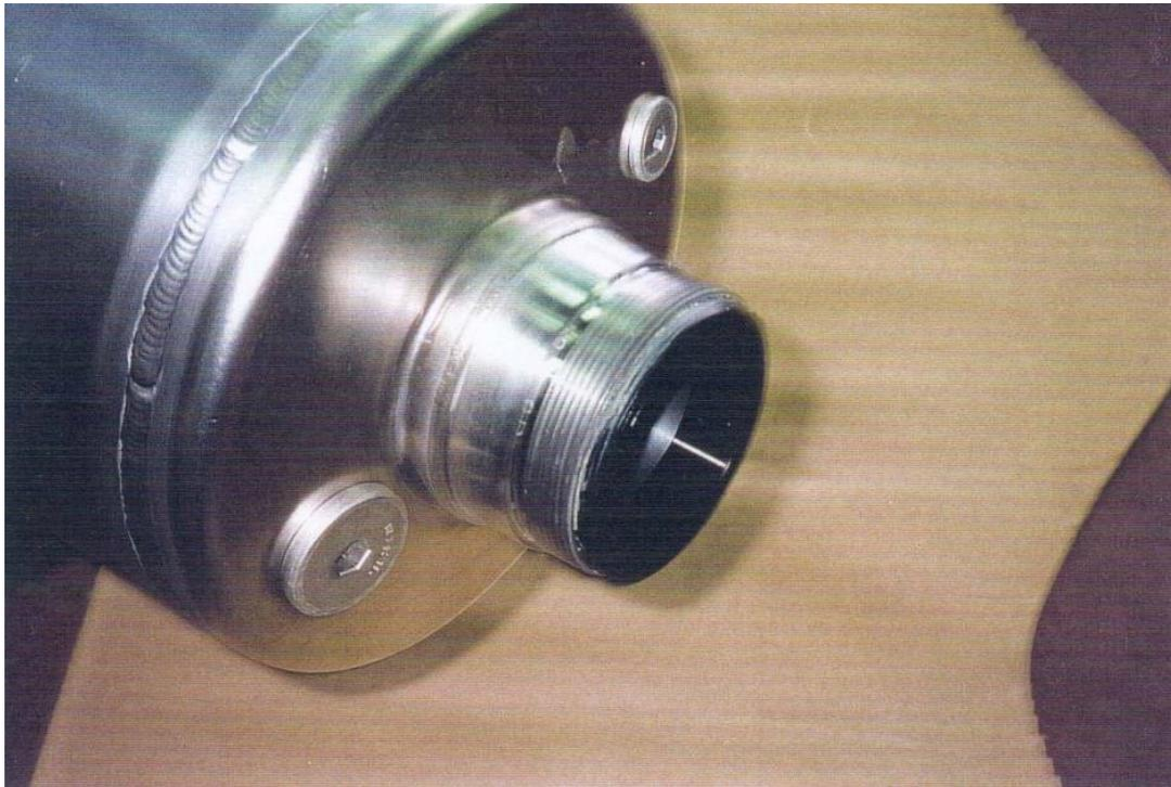
**Фото 4. Монтаж внутренней контактной шпильки с надетым на неё уплотнительным кольцом**
