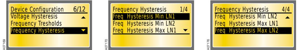
Figura 7.37 Impostazioni (min e max) dell'isteresi della frequenza per la Linea 1 e la Linea 2
