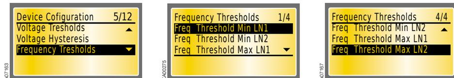
Figura 7.35 Impostazioni (min e max) delle soglie della frequenza per la Linea 1 e la Linea 2
