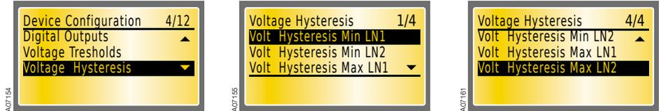
Figura 7.32 Impostazioni (min e max) dell'isteresi della tensione per la Linea 1 e la Linea 2
