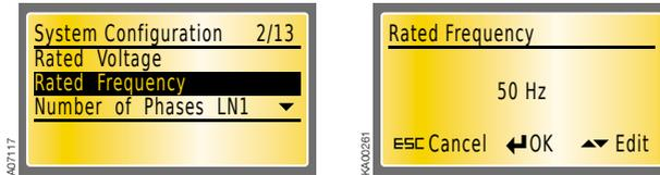
Figura 7.11 Rated Frequency, l'impostazione di fabbrica è 50 Hz
