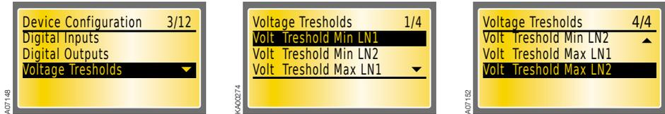
Figura 7.30 Impostazioni (min e max) delle soglie di tensione per la Linea 1 e la Linea 2
