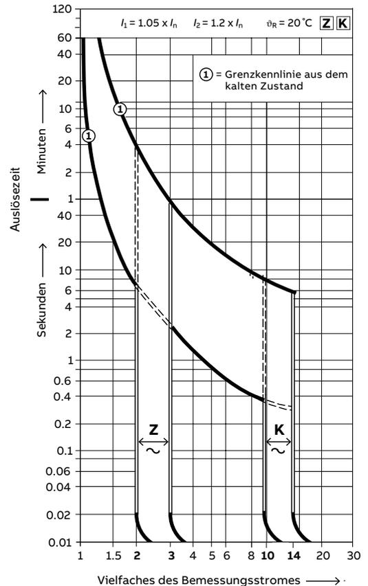
**Abb. 4 Auslösekennlinien B/C/K/Z im Vergleich**
