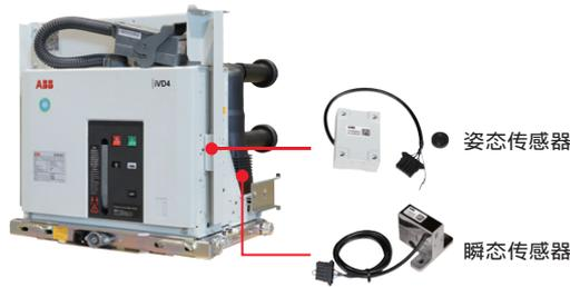
通过姿态传感器提取断路器机构运动曲线实时监测断路器机械运动状况, 借助ABB先进的数学模型计算出多项断路器机械特性参数, 覆盖大部分年检参数。
