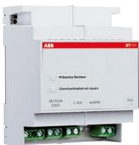
Ce boîtier de commande permet de piloter la fonction Visibilité + des blocs de secours compatibles V+ et de marque KAUFEL®. Les modes de déclenchement sont réalisés par commande manuelle ou automatique (tels qu'un système de surveillance, du type alarme incendie/intrusion...) via, au minimum, l'ouverture d'un contact libre de tout potentiel.
