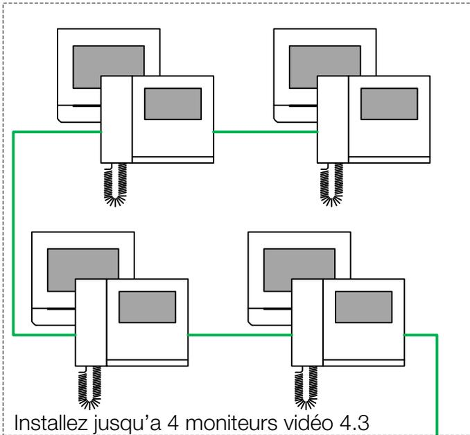
Installez jusqu'à 4 moniteurs vidéo 4.3 dans un logement équipé d'une unité centrale compacte.
