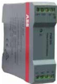
PSM005电源模块为导轨式开关电源，采用世界上先进的单片电源技术，具有输入电压交直流通用、输入范围广、保护功能齐全等优点，并且体积小、外形美观，安装和接线方便，是M101或M102电动机保护与控制装置配套使用的专用直流电源，也可作为其它自动化设备的电源供给。
