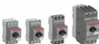
电动机保护用断路器是主电路的机电保护装置。它们主要用于手动开/关电机, 并提供无熔断器保护来防止短路、过载和断相。无熔断器保护能在几毫秒内关闭电机, 因此可节省成本、空间并确保短路条件下的快速反应。电动机保护用断路器组合与接触器一起设置, 可提供螺钉或插入式弹簧端子。
