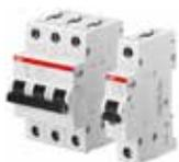
微型断路器可保护电气装置免受过载和短路影响，确保操作的可靠性和安全性。System pro M compact S200系列是限流过流保护装置。它们具有两种不同的脱扣机制，即用于过载保护的延时热脱扣机构，和用于短路保护的磁性脱扣机构。
