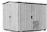
紧凑型二次变电站 (CSS) 是预制变电站，包括 低压配电盘、变压器和中压开关设备。CSS已经通过内部电弧测试，获得了更高的安全性。ABB CSS产品组合涵盖不同的外壳材料，包括钢和玻璃纤维增强聚酯 (GRP)。后者是一种创新材料，它兼具钢和混凝土外壳的优点。通过选择合适的外壳材料，CSS可适用于恶劣和苛刻的环境条件。
