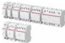
ESB建筑用接触器提供完整的产品组合 (从16到100A), 主要用于开关和控制照明、加热、通风、电机和泵。它们适用于多种不同的条件和环境, 设计上与ABB模块化DIN导轨组件相匹配, 可轻松集成到专用盘柜中。EN接触器还具有用于自动和手动应用内置拨动开关。整个产品系列都提供无需工具的辅助触点块。
