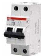
POD可以消除SPD突然短路、老化劣化高温起火的隐患。POD安装于电涌保护器前端，在高幅值的雷电流(25kA 10/350μs、120kA 8/20μs)冲击下，不误动不损坏，确保SPD有效防雷；当SPD发生故障出现小工频电流时，快速分断，确保供电网络及设备的安全。
