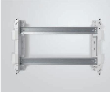
Il telaio estraibile rende più agevole e rapido il cablaggio realizzato a banco. Degli appositi fori asolati ne permettono il successivo e rapido fissaggio all'interno della scatola per il montaggio a parete.
