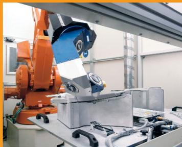
Déchargement et post-moulage de pièces, incluant l'impression, l'assemblage et le contrôle qualité, à l'aide d'un ensemble de cellules de production modulaires et facilement interchangeables.
