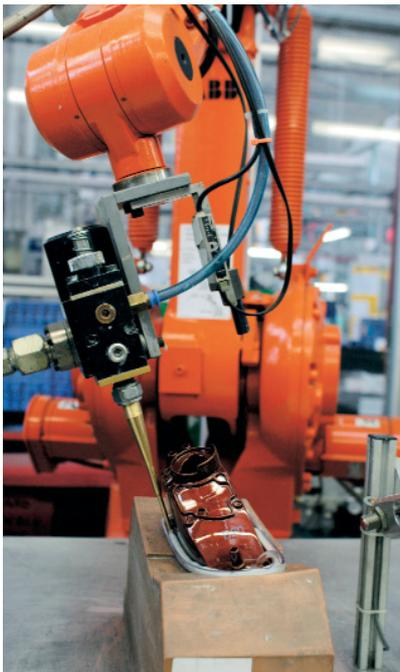
Le logiciel RobotWare Dispense, destiné aux applications d'encollage et de dépose de mastic, accélère la programmation de nouvelles pièces. Le temps de cycle et la qualité des applications sont également optimisés.
