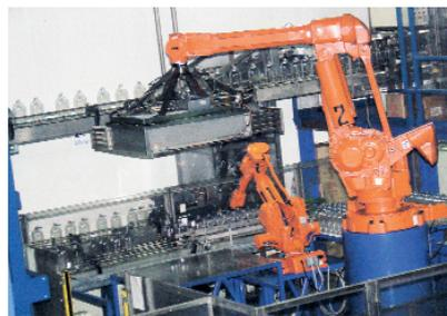
Un processus totalement automatisé où les bouteilles en plastique arrivent sur les stations robotisées en provenance de la machine d'extrusion-soufflage. Toutes les heures, ce sont 4 000 à 60 000 bouteilles qui sont traitées et palettisées. Une fois pleines, les palettes sont acheminées vers les usines de remplissage.
