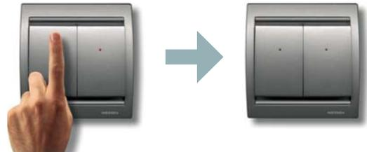
e.- Tras 2 segundos, tanto el LED del canal actuador como el del canal remoto, se iluminarán en verde de forma intermitente durante 3 segundos.
