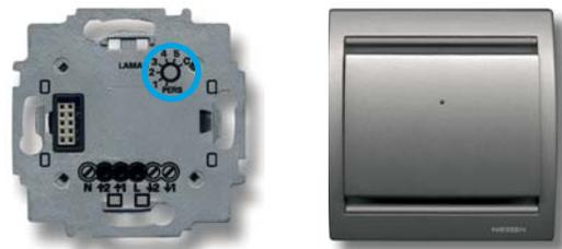
3.4.3.- Para que el interruptor de relé pueda activarse con las señales de la fuente de alimentación es necesario asociar las dos teclas. Para ello, se deberá presionar primero sobre el botón de configuración de la tecla con conector que va sobre el interruptor relé. Se encenderá el LED rojo de la tecla de forma continua.
