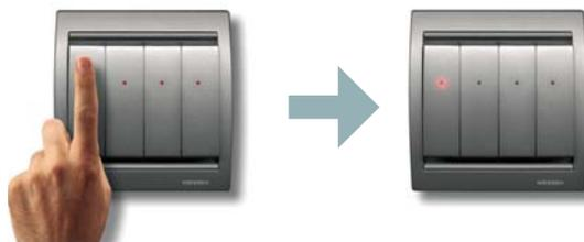
2.2.3.- Presione sobre el botón de configuración de la tecla con pila (tecla a). A continuación se encenderán los LEDs rojos de todos los canales de la tecla a de forma continua.
