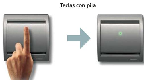
3.3.11.- Pulse sobre la parte superior de la tecla, si se desea almacenar la escena en la parte superior de la tecla, de forma que para apagar todas las cargas se deba presionar en la parte superior de la tecla. Si por el contrario, lo que se busca es que el usuario presione sobre la parte inferior de la tecla para apagar todas las cargas, se deberá presionar en la parte inferior. El LED verde de la tecla se apagará.
