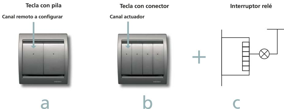
2.2.1.- Presione sobre el botón de configuración de la tecla con conector (tecla b). A continuación se encenderán los LEDs rojos de todos los canales de la tecla b de forma continua.
