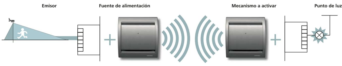
Cuando el sensor/interruptor se desactive o deje de detectar, la fuente de alimentación percibirá un cambio de estado y emitirá una señal de apagado al mecanismo activado anteriormente. Volviendo al ejemplo anterior, una vez que el detector deje de enviar la señal a la fuente de alimentación, la tecla sobre la fuente de alimentación emitirá una orden de apagado a la tecla sobre el mecanismo, de forma que el punto de luz se apagará.
