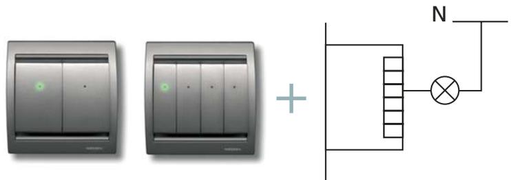
2.2.6.- La tecla con pila ya está preparada para actuar sobre la carga de forma remota.
