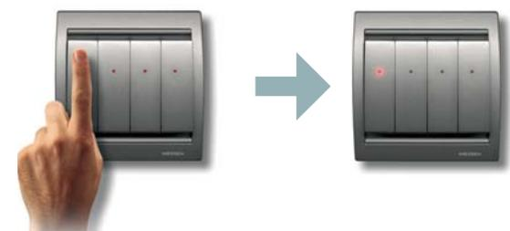
c.- Presione sobre el botón de configuración de la tecla con pila (tecla a). A continuación se encenderán los LEDs rojos de todos los canales de la tecla a de forma continua.
