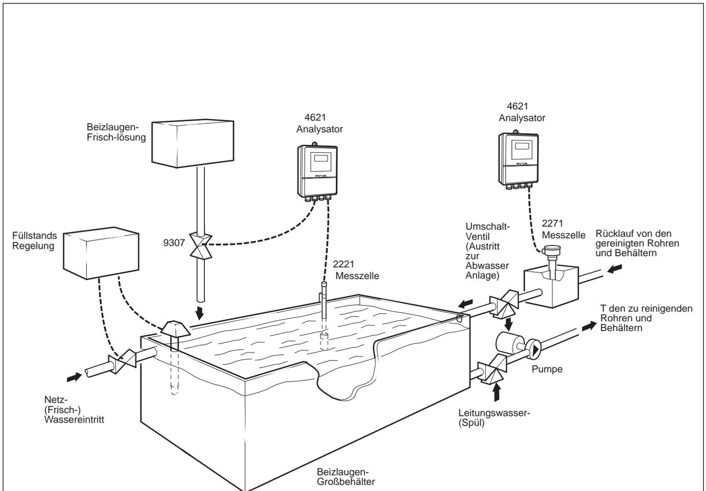
Typisches Leitfähigkeitsüberwachungssystem in einem automatischen Reinigungssystem
