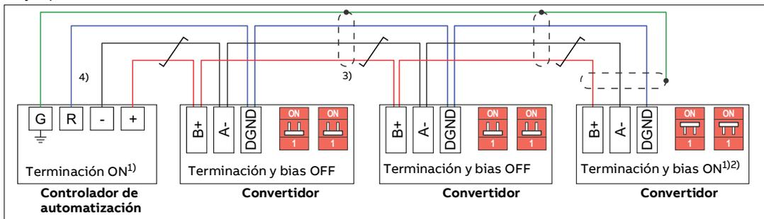
1) Los dispositivos de los extremos del bus de campo deben tener terminación ON. Todos los demás dispositivos deben tener terminación OFF.
