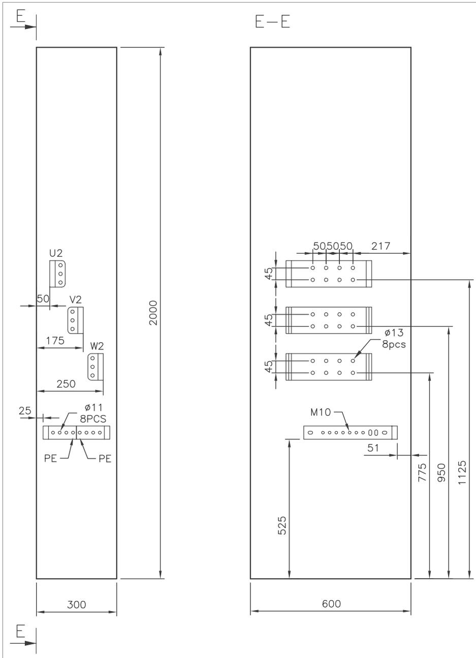
**Cubicle width 300 mm, top cable exit**
