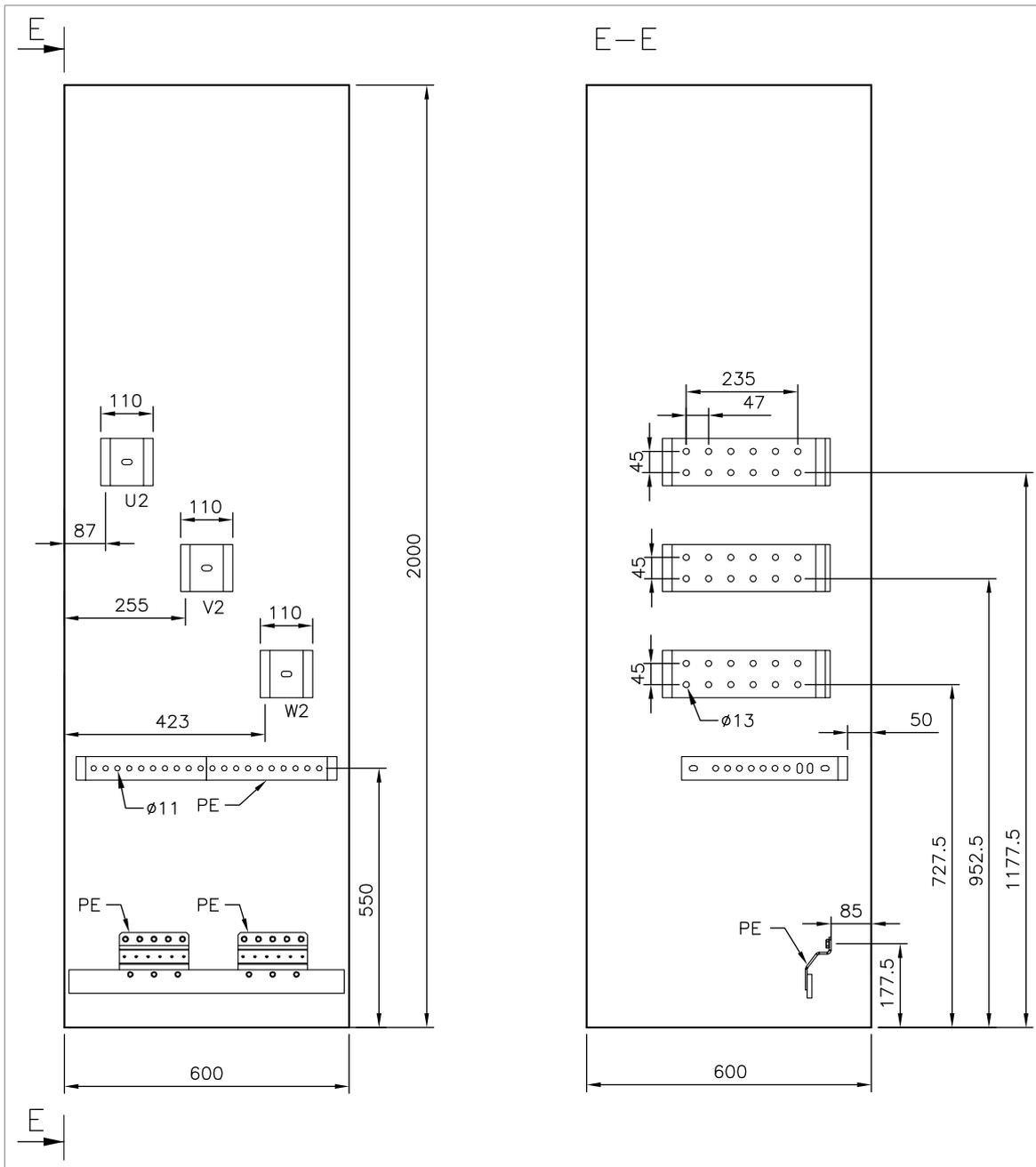
**Cubicle width 600 mm, top cable exit**
