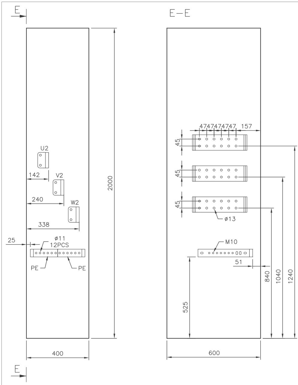
**Cubicle width 400 mm, top cable exit**
